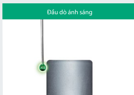
Vì áp lực đo cực kỳ thấp nên có thể phát hiện được mà không ảnh hưởng đến bộ phận
